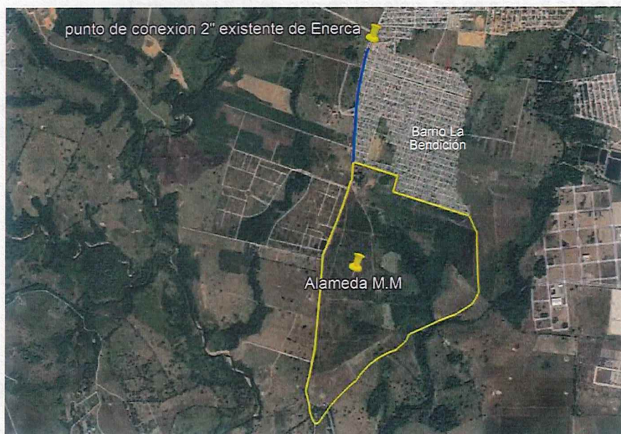
Ilustración 1 Localización de la Zona de Conexión a la Red de 2 o de gas natural en el Barrio La Bendición Fuente: Archivos del proyecto del municipio de Yopal
